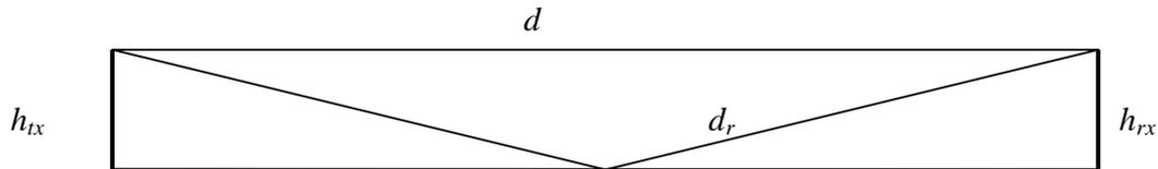
Il valore massimo della differenza  $d_d = d_r - d$  si ha quando  $d_r = h_{tx} + h_{rx}$  e  $d = 0$ . Per le grandezze in gioco nel caso microcellulare in esame al massimo si avrà circa perciò  $d_d \sim 6$  m. In tal caso il ritardo è pari a  $6/3e8 = 20$  ns, di molto inferiore al tempo di chip. Questo significa quindi che il cammino riflesso risulta sempre indistinguibile dal cammino diretto.
