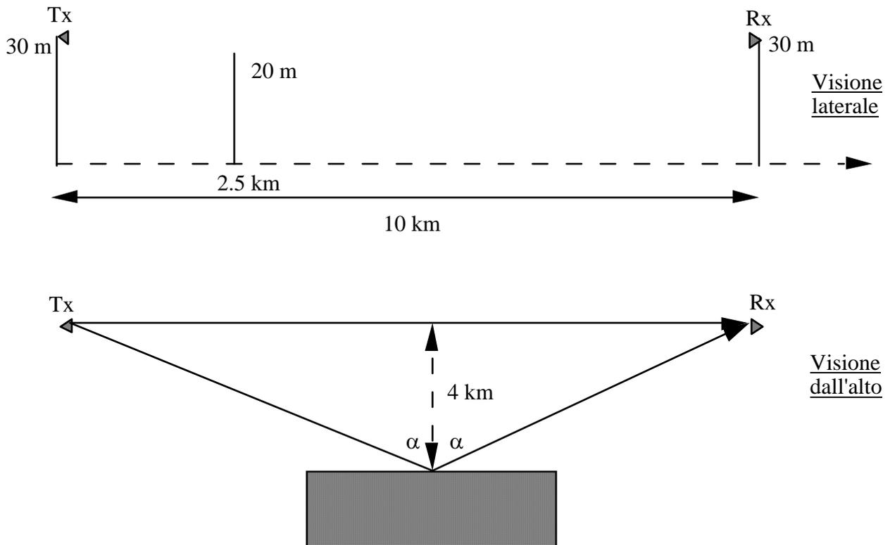
Un ponte radio numerico a 6 GHz in ambiente urbano è caratterizzato dal profilo di tratta illustrato in figura. Le antenne utilizzate si possono supporre omnidirezionali ai fini del problema. È presente un ostacolo (vedi visione laterale) sulla linea di vista che provoca diffrazione e un edificio (vedi visione dall'alto) che determina un cammino riflesso laterale. Si assuma che l'edificio sia di metallo ideale. Si trascuri la presenza del terreno.
