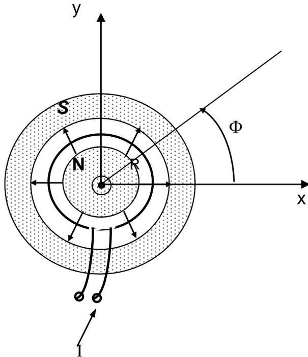
Il gap fra i 2 magneti è supposto molto piccolo, in modo che **il campo magnetico radiale** (indicato dalle frecce in figura) si possa **supporre uniforme in modulo**. Si supponga inoltre di alimentare la spira con un generatore ideale di tensione, e una resistenza in serie con tale generatore.
